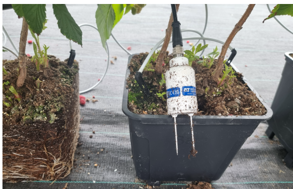
En fuktsensor kan hjälpa till med bevattningsstyrningen
