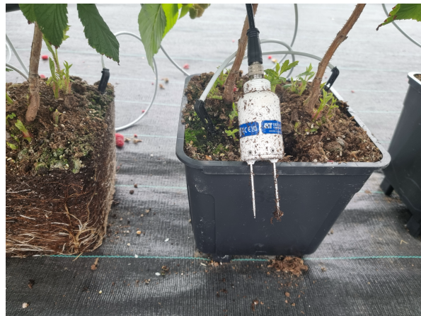
Fuktsensor som är kopplade till en logger ger en överblick av upptaget under dygnet.
