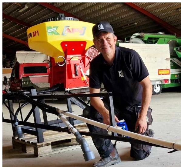
Figur X. Spridarbommen är försedd med 5 ramprör och har en arbetsbredd på 6 m med cc-avstånd på 1.5 m. För framkomligheten är bommen tredelad för en transportbredd på ca 2 m.
