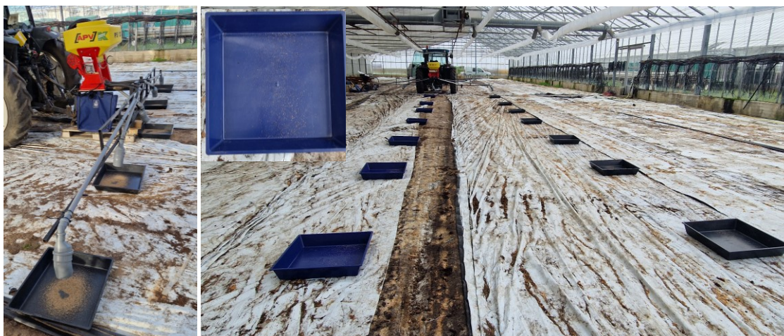
Figur X. Bild till vänster visar spridartest tvärs körriktningen med 5 rader som jämfördes mot varandra. Spridartestet genomfördes över tid för att öka mätnoggrannheten, men även vid överfart i samband med test. Bild till höger visar uppställning av provbackar vid samtidig spridartest längs körriktningen för två rader, mitten och yttre. Inflikad bild på provback visar den mängd formulering som fångas upp i provbacken. Det är avsevärt mindre mängd/vikt än vid gödseltester och kräver därmed hög upplösning på våg vid test.
