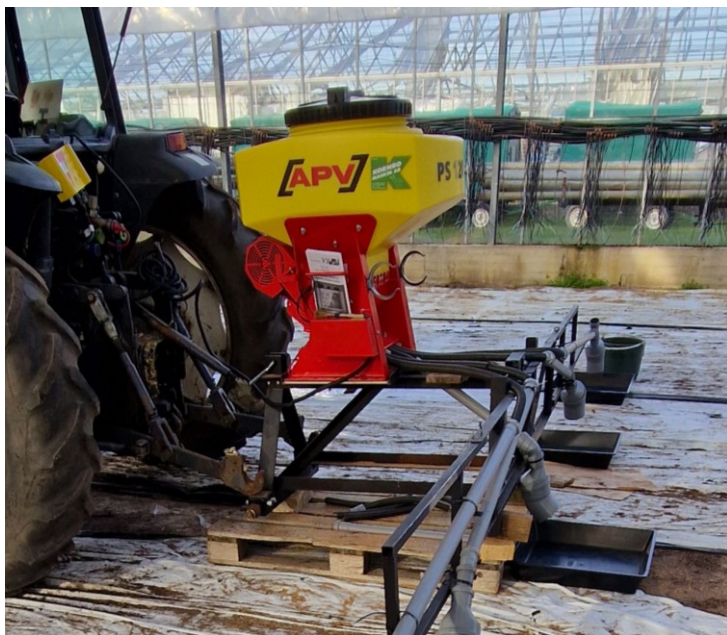
Figur X. Ramen tillkopplas med traktorns trepunktkoppling. Ovanpå ramen monteras frösåmaskinen. En fällbar ramp om tre sektioner hängs upp bak på ramen i nivå under utloppet på frösåmaskinen.
