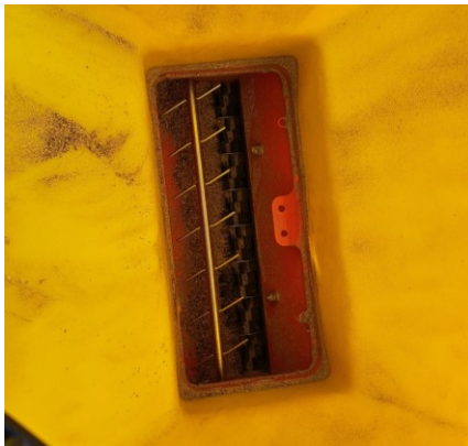
Figur X. Effektiv omrörning saknas i dagsläget, men det finns en "matare" i tanken ovanför valsen.
