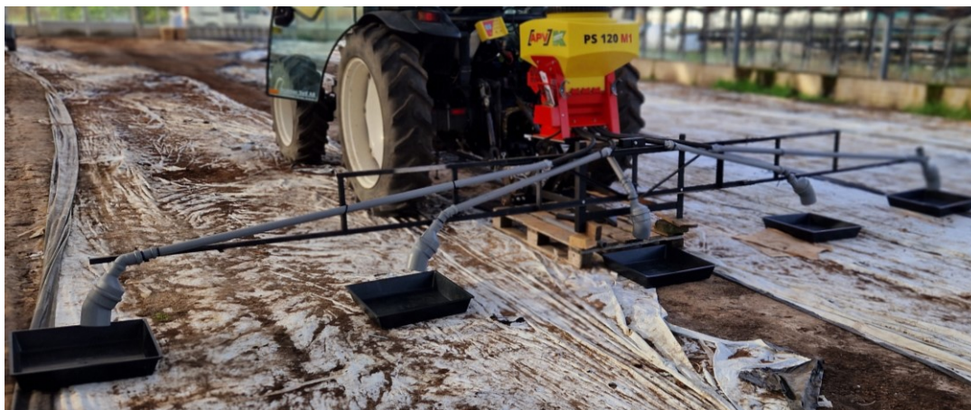
Figur X. Spridarbommen är försedd med 5 ramprör och har en arbetsbredd på 6 m med cc-avstånd på 1.5 m. För framkomligheten är bommen tredelad för en transportbredd på ca 2 m.
