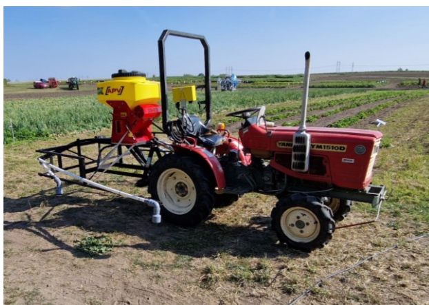
Figur X. Spridarkonceptet är avsett för att olika stora traktorer ska kunna användas vid spridningen. Från mindre och lättare trädgårdstraktor som här exempelvis äldre Yanmar 26 hkr i bild till vänster och liten jordbrukstraktor New Holland 75 hkr i bild till höger.
