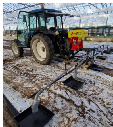
Figur X. Spridarkonceptet är avsett för att olika stora traktorer ska kunna användas vid spridningen. Från mindre och lättare trädgårdstraktor som här exempelvis äldre Yanmar 26 hkr i bild till vänster och liten jordbrukstraktor New Holland 75 hkr i bild till höger.
