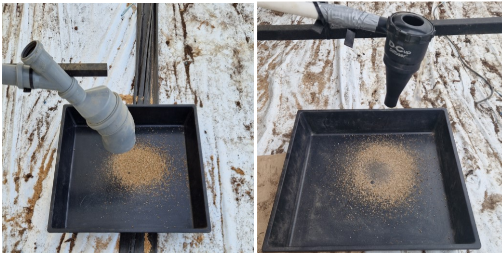
Figur X. Luftevakuering vid utloppet med y-förgrening innan utloppet i vänster bild. Höger bild visar den s.k difusern med cyklonfunktion.
