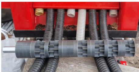
Figur X. Såaxeln, till vänster i bild, består av sådiskar som kombineras utifrån aktuellt material att sprida. Varje rad/utlopp regleras av tre alternativt fyra diskar beroende på diskarnas bredd.
