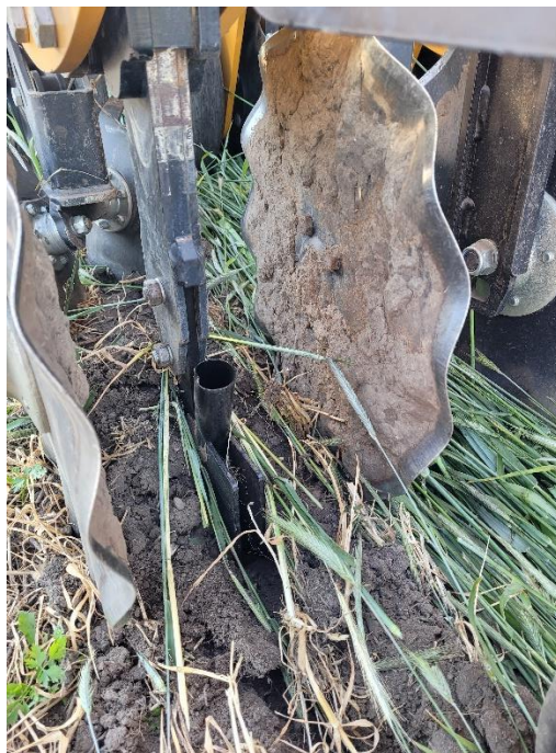
Figur 10. StripCat djupluckrande pinne i raden med skyddstallrikar som begränsar bearbetningen till raden. Foto: Jonas Jönsson; HIR Skåne AB
