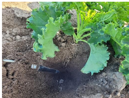
Figur 5. Markfuktsensorn från Paultech vars probe installerades i raden rakt under en kålplanta med spetsen ca 20 cm under markytan. Foto: Jonas Jönsson; HIR Skåne AB
